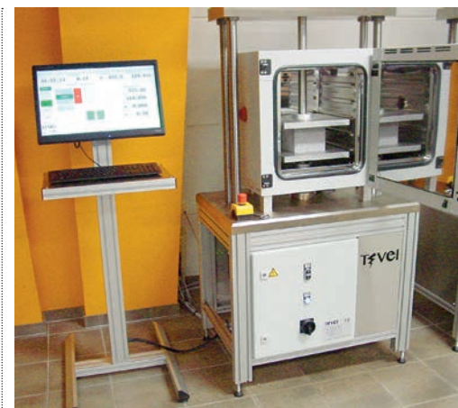
Kiwa BDA Testopstelling: bepaling lange duur druksterkte.
