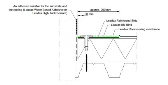
Figure 4 - Edge fixation, with edge strips
