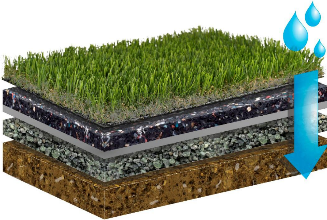
Abbildung 1: Aufbau des Kunstraseneinbausystems mit Eco2Sand® der 7SevenRelax Group GmbH
