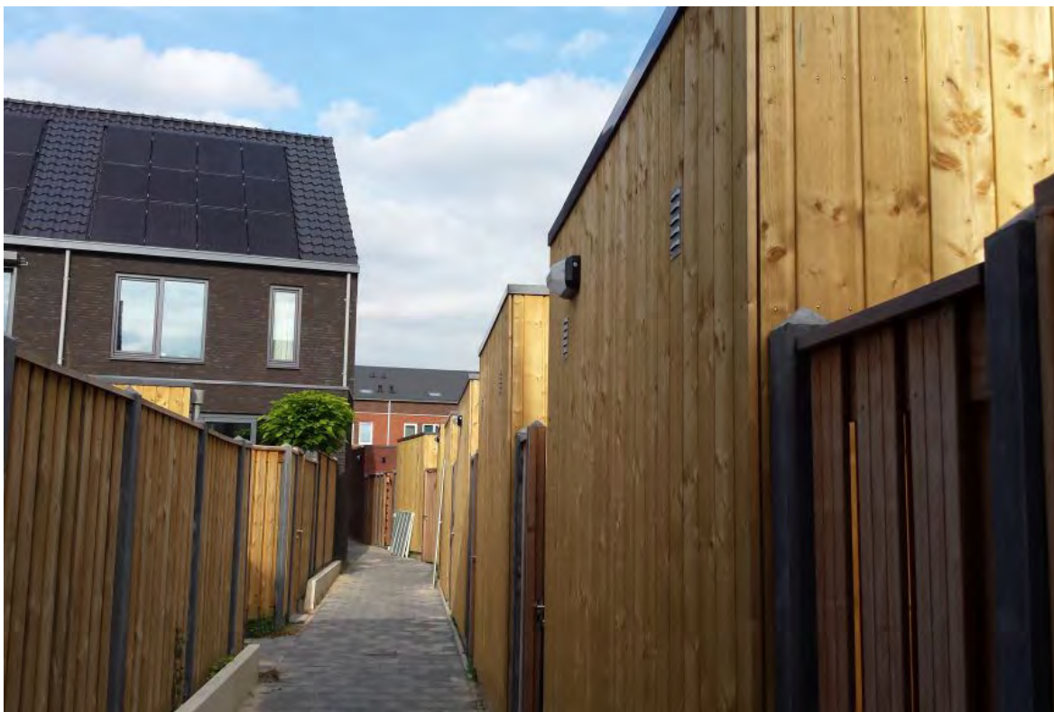
Veilig achterpad met verlichting aan elke berging. Verlichting in het achterpad geeft de beste lichtopbrengst, maar denk wel aan lichthinder.
