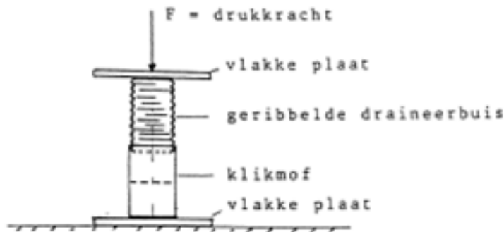
Figuur 1 - Proefopstelling bepaling montagekracht
