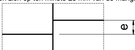
Figuur bijlage 8.2: Afstand langснаad aansluitende delen
