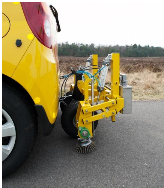
Figuur 2 Veeginstallatie FCM
