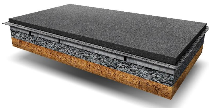
Abbildung 1: Asphaltbelag mit HaTelit® (zweite Schicht von oben)
