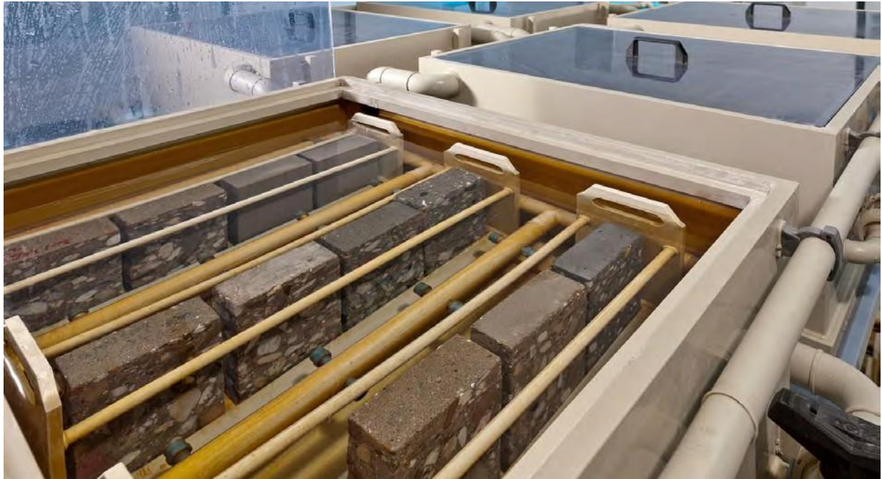
Abbildung 3 Prüfanlage zur Einlagerung der Probekörper in Säure
