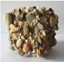
Beispiele für die Korrosion von Betonen bei Einlagerung in Schwefelsäure: Bei Verwendung von unlöslicher Gesteinskörnung erfolgt der Abtrag ausschließlich über den Zementstein (s. A + B). C zeigt Beispiele bei UHPCs (hier pH: 2,5).
