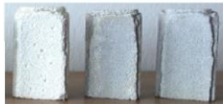
Beispiele für die Korrosion von Betonen bei Einlagerung in Schwefelsäure: Bei Verwendung von unlöslicher Gesteinskörnung erfolgt der Abtrag ausschließlich über den Zementstein (s. A + B). C zeigt Beispiele bei UHPCs (hier pH: 2,5).
