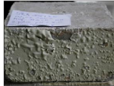
Beispiele für Korrosionseffekte bei der Einlagerung von Polymeren in Schwefelsäure: die Zugfestigkeit des Materials ist ein wesentlicher Indikator des Korrosionsprozesses, weiterhin kann es zu einer Versprödung mit Abblättern der Beschichtung kommen (hier pH: 1)
