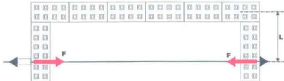
Figuur B.2 – Belastingschema buigproef
