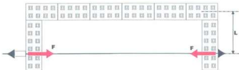
Figuur B.2 – Belastingsschema buigproef
