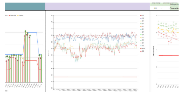
Painelaite- ja NDT-tarkastuksien tulokset koostetaan yhtenäiseen asiantuntijalausuntoon ja kattilan kunnonseurantaohjelmistoon, joka toimii huoltokirjana ja työkaluna suunniteltaessa tulevia tarkastus-, korjaus- ja uusimistoimenpiteitä.
