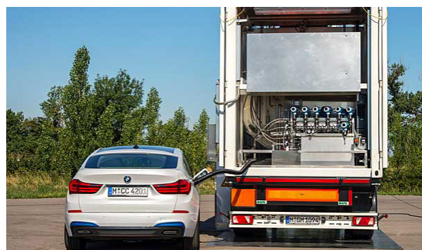
Foto: De BMW 5GT brandstofcelauto en een mobiel vulstation voor 350 bar cryo-gecomprimeerd waterstofgas. De CC op de nummerplaat verwijst naar de opslagmethode. De luchtinlaat en waterdampuitlaat van het BMS zijn blauw geaccentueerd en geïntegreerd in de zwarte achterbumper.
