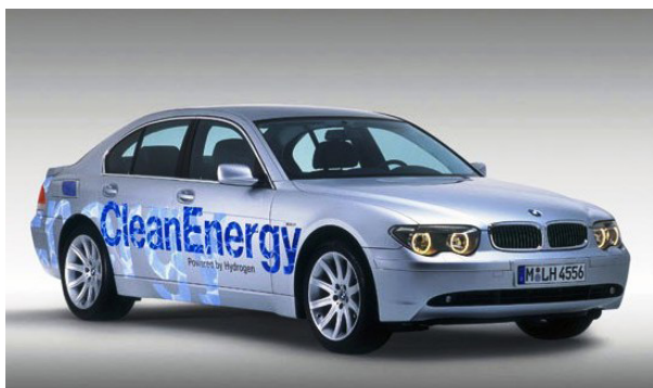
Foto: BMW Hydrogen 7 met 5 bar vloeibare waterstoftank en BMS.
